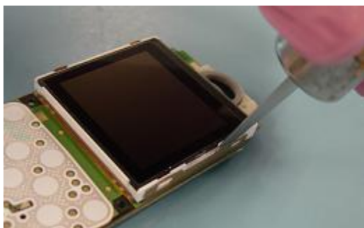
Remove Display module.
